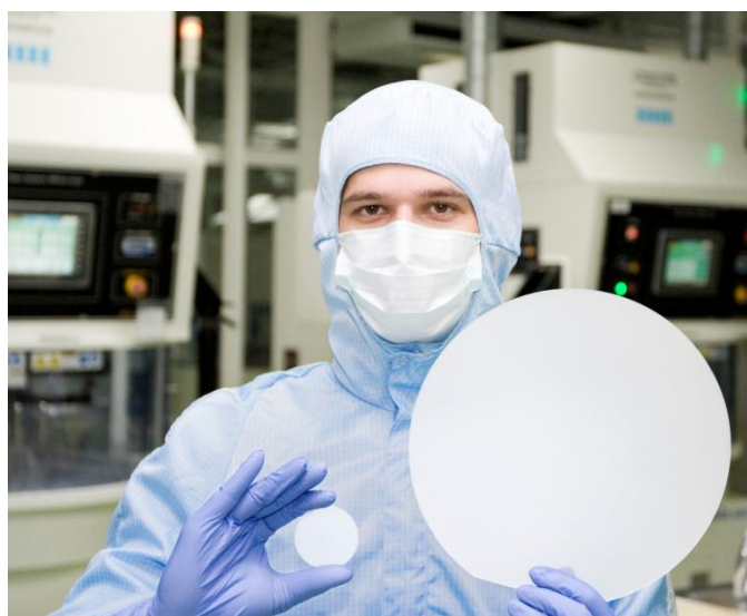
10-дюймовая пластина сапфира в сравнении с 2-дюймовой
